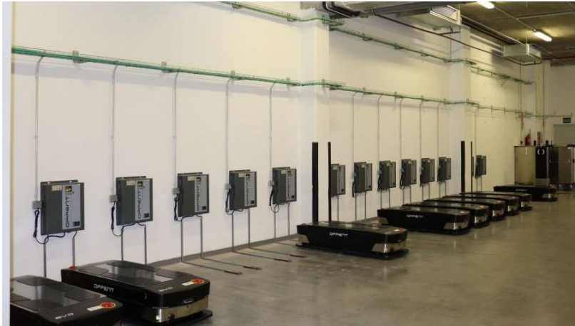
Estaciones de carga para los robots móviles fabricados por Oppent para el CAUSA en Salamanca
